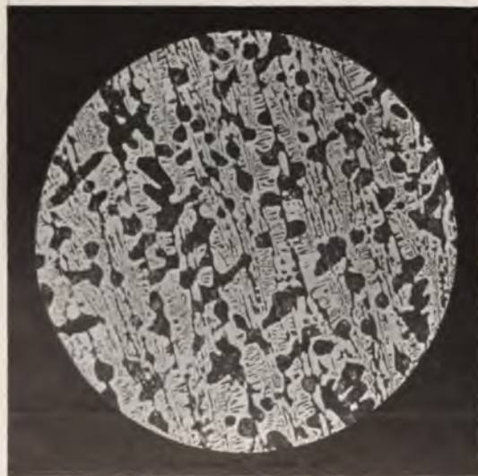
Fig. 139. Weißes Roheisen. Perlit dunkel, Cementit hell.
